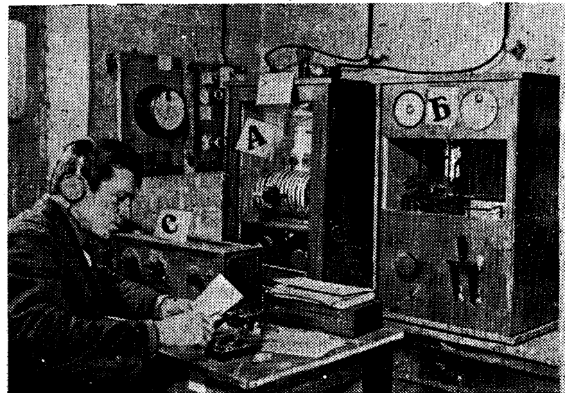
Радиостанция коллективного пользования. А — передатчик, Б — выпрямитель для передатчика, С — коротковолн. приемник—КУБ—4.
